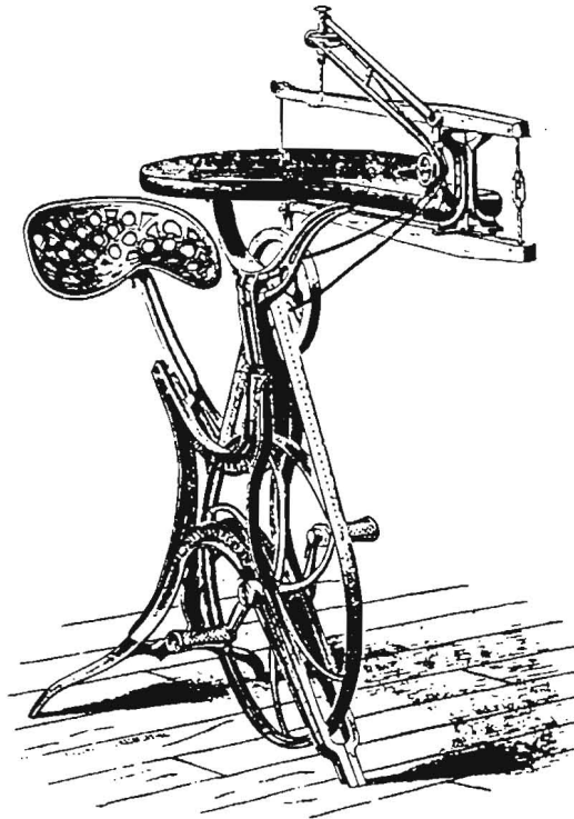
Konträrsåg med sk velocipedtramp. Ur "Handbok för val och inköp af hjälpmaskiner och handverktyg", 1890.
